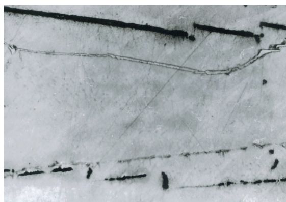
Foto 4. Waterstof geïnitieerde scheurvorming
